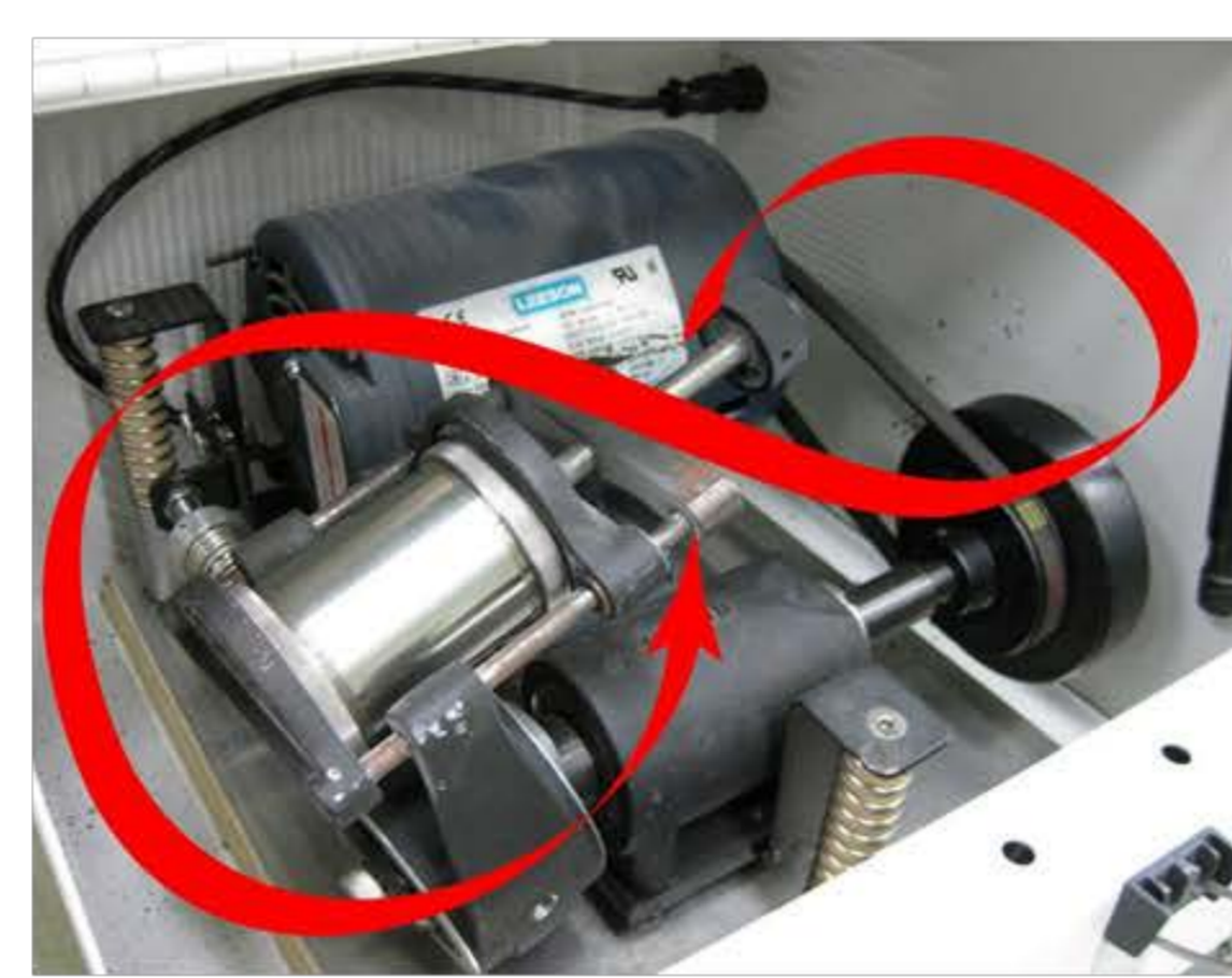
粉末の塑性変形、粉碎により、組織の微細化、ひずみの蓄積、強化粒子の均一分散を図る
